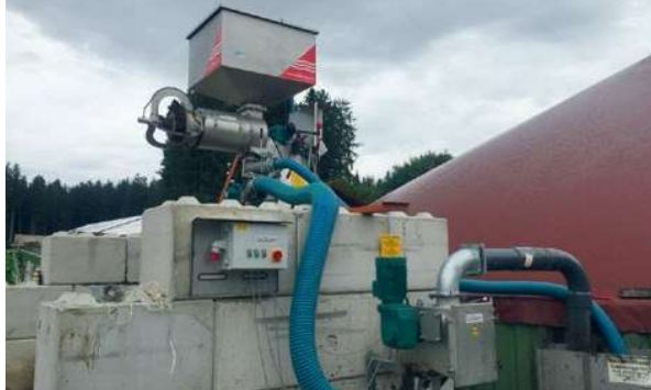
L'unité mobile « Small » PSS 5.5-550 séparant les résidus de fermentation. PSS 5.5-550 Unità mobile Small separa residui di fermentazione
