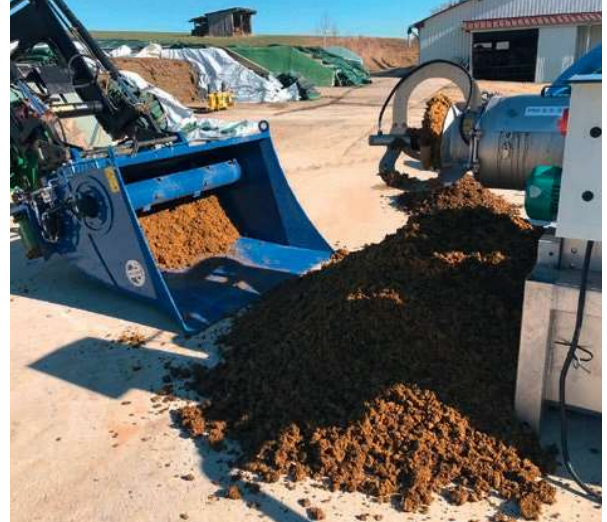
PSS 5.5-550 produit des substances solides avec plus de 30 % de matière sèche comme litière. | PSS 5.5-550 produce solidi con oltre il 30% di contenuto di sostanza secca per lettiera.
