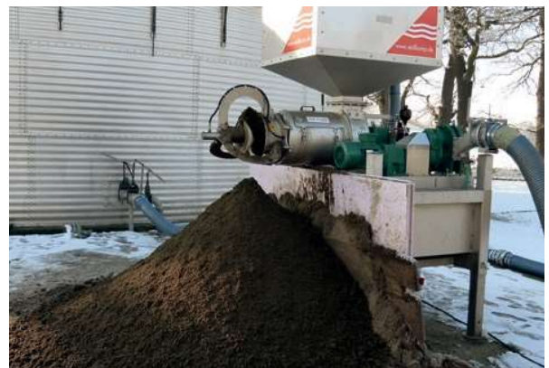
Le PSS 4-550 avec les pieds sortis en pleine séparation pour désengorger la fosse à purin. | PSS 4-550 separa con supporti prolungati e alleggerisce il magazzino fanghi.
